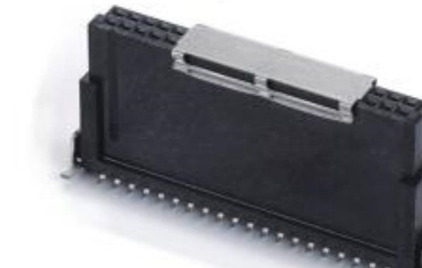
1.27MM H8-18.6 母座 12-80PIN 料号: LXW1272S-XXSG5-SM-1365CR
